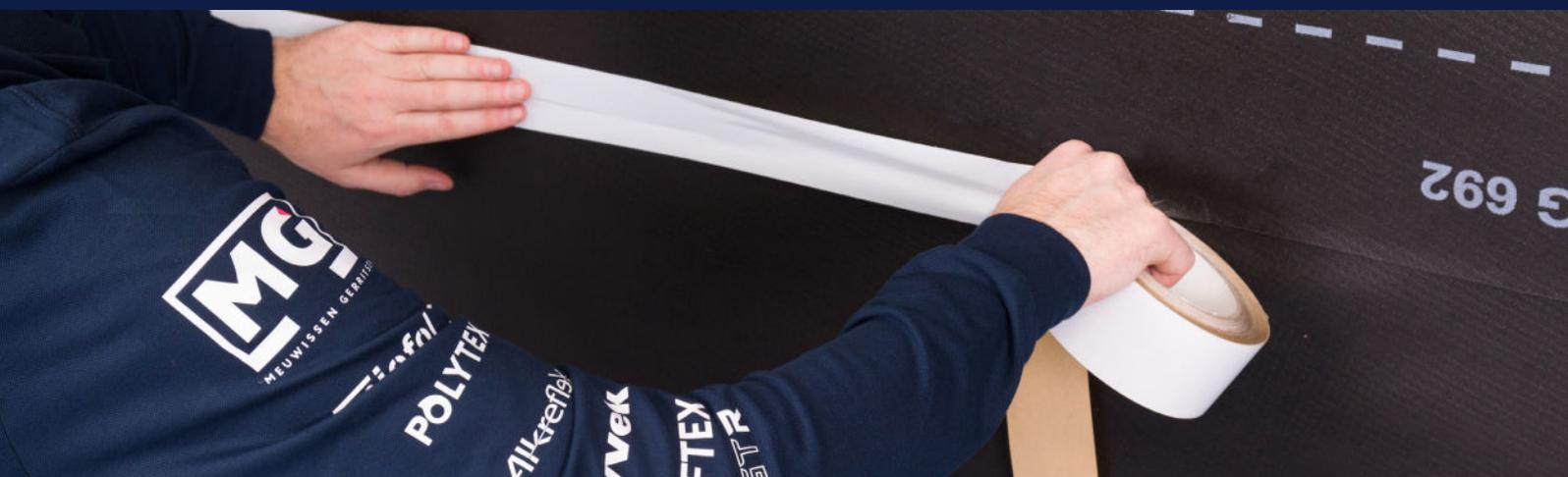
La bande adhésive VASTR® totale est un ruban adhésif simple face et est universellement applicable pour les films et l'étanchéité à l'air de l'enveloppe du bâtiment. Le ruban, en version noire ou blanche, est doté d'une couche adhésive haute performance VASTR®. La couche supérieure du ruban est résistante aux UV pendant deux ans, ce qui permet de l'utiliser à l'intérieur comme à l'extérieur.
